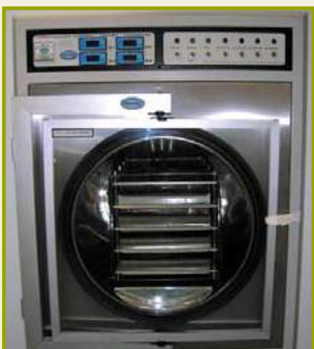
Liofilizadora para o processamento do tecido ósseo que será armazenado em temperatura ambiente
